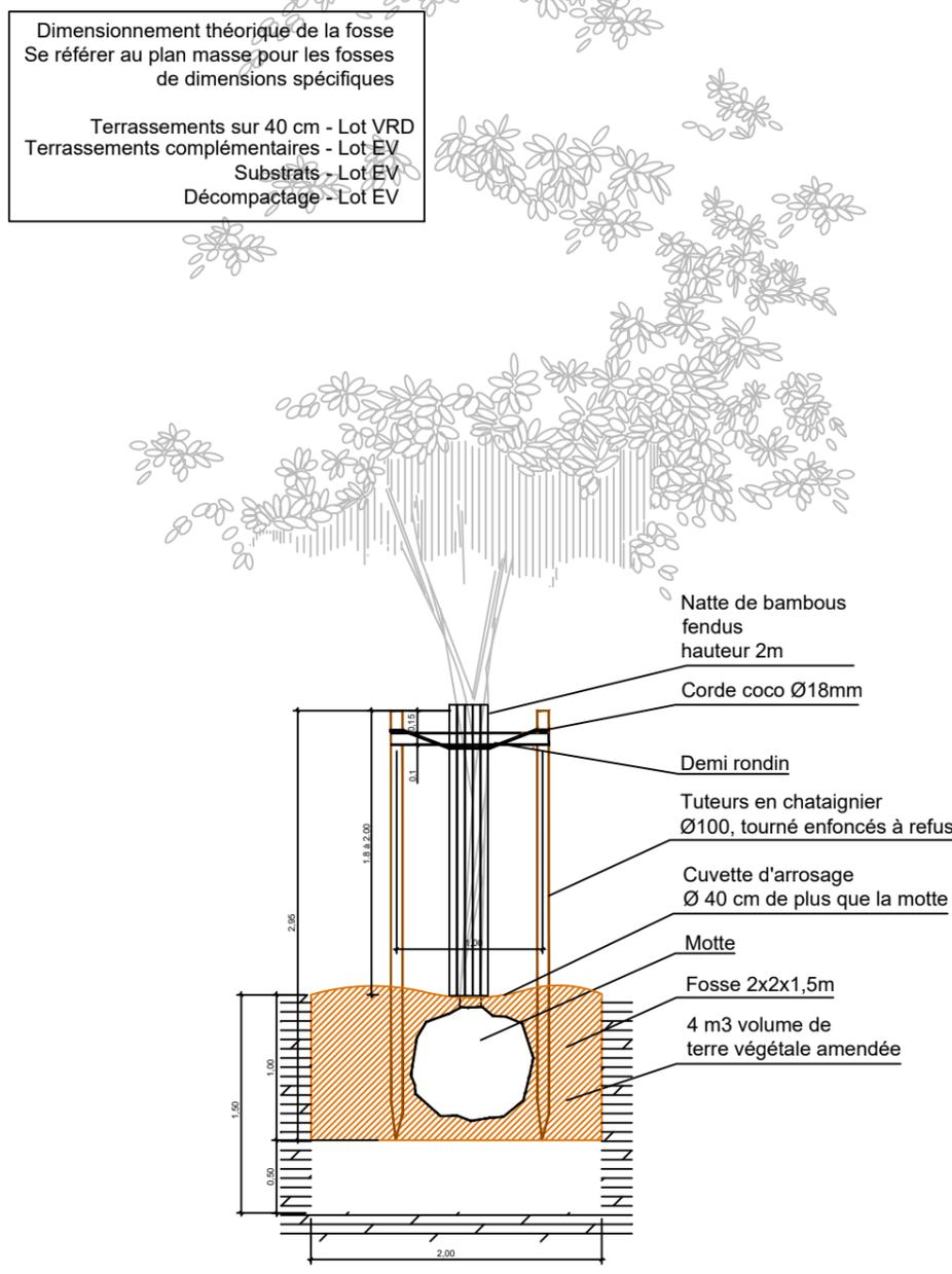
Coupe de principe - plantations d'arbres inférieur à 25/30- 1/25e
