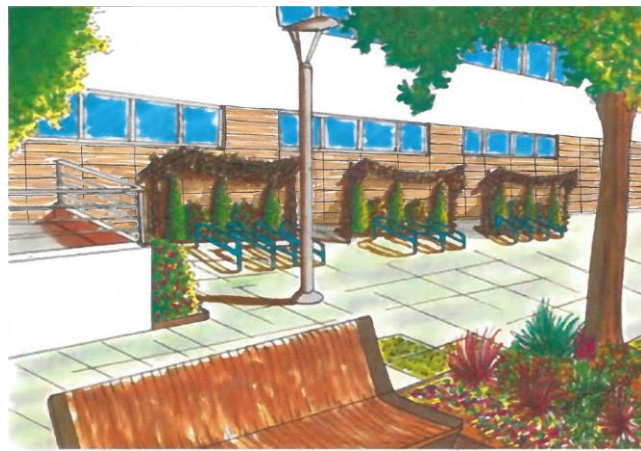
Façade EE Joliot-Curie 4. Bardage bois au Rdc puis peinture blanche
